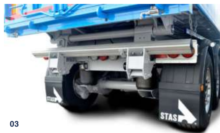
01 chapas antidesgaste en las paredes laterales 02 faldón trasero automático en toldo corredero 03 paragolpes con accionamiento neumático 04 luces de emergencia traseras
